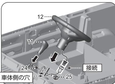
プラグを接続し、車体側の穴に入れ、ハンドル(部品12)をステアリングロッドの先端に取付けます。その後、ハンドル用ネジ(部品24)とハンドル用ナット(部品25)で固定し、最後にシフトレバー(部品11)を差し込みます。
