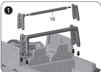
ガードバー(部品16)は、左・中・右の3部品を接続して組み立て、車体両側の図の位置に差し込み、しっかりと締め固定します。
