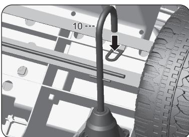
ステアリングロッド(部品10)を車両前方の図の位置に差し込みます。
