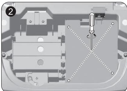
中面のバッテリーカバーのネジを4本外します。
