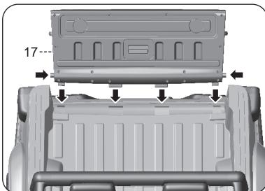
トランクドア(部品17)両端のスピンドルを内側に押し込み、車両後部の図の位置に差し込み、固定します。
