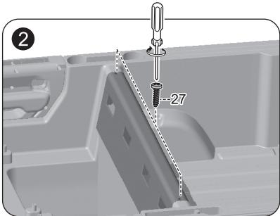
トランクボード(部品13)を図の位置に取付け、トランクボード用ネジ(部品27)を締めます(2箇所)。
