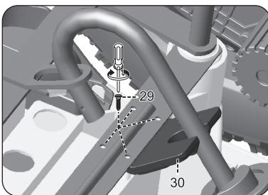
スイングレバー固定ブロック(部品30)を前輪車軸の下に置き、ステアリングロッドを引っ掛けてスイングレバー固定ブロック用ネジ(部品29)を図の穴に締めつけます(4箇所)。
