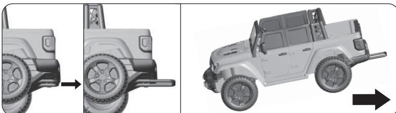
車体後部の底面にあるハンドルを引き出して運搬などに使用できます。
