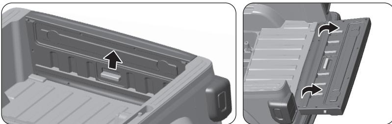
トランクドアのスイッチを引き上げるとロックが解除され、外側に開きます。
