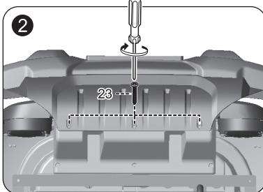
フロントバッフル(部品9)を図の位置に取付け、車体の底面からネジ(部品23)を締めます。
