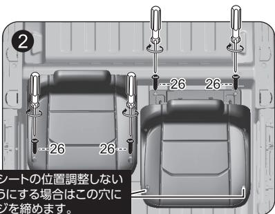
助手席シート(部品14)のジョイントを図①の位置に取付け、シート用ネジ(部品26)で締め付けます(2箇所)。次に、運転席シート(部品14)を図①の位置にはめ込み、シート下のレバーを引き上げて前方に引き出し、図②の位置をシート用ネジ(部品26)で締めつけます(2箇所)。※運転席シートを位置調整出来ないようにする場合は、シート手前のネジ穴を使用して取付けます。シート調整についてはP.8をご確認ください。
