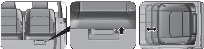
シート下のレバーを引き上げると座面の前後位置を3段階に調整できます。
