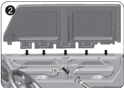
左右のウィンドウ(部品15)を車体両側にある取付け位置に差し込み、軽く押し込んではめ込み、ウィンドウ用ネジ(部品28)で締めつけます(6箇所)。
