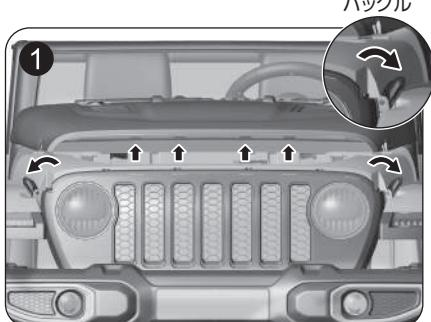
ボンネット両側のバックルを引いて前面カバーを開けます。
